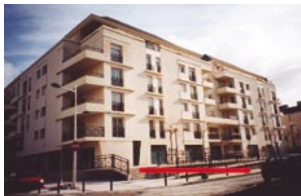
Îlot n°2. Le niveau du rez-de-chaussée est à 50 cm au-dessus du niveau de la crue de 1995 [Roseline Quiko, CETE Normandie Centre]
