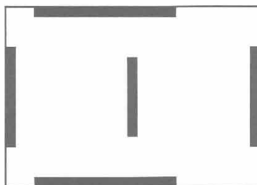
Figure 3-18 : Disposition de panneaux de contreventement perpendiculaires
